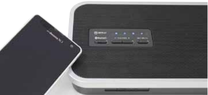
R-Talk 800EX與手機連結時，除了可使用手機連接端子，也可利用無線藍芽通信。
